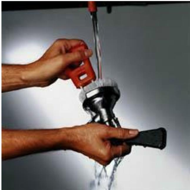
Fitting und Zapfkopf mit fließendem Wasser und den hierfür bereitgelegten speziellen Fittingbürsten reinigen.
