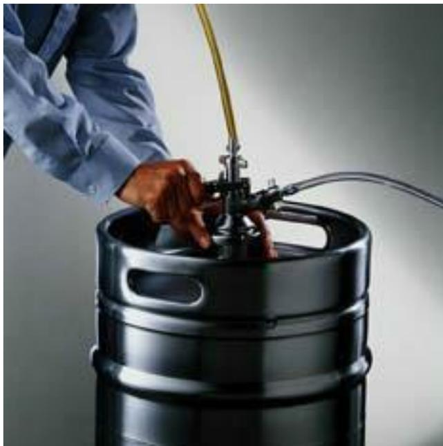
Drücken Sie den Hebel nach unten. Dadurch werden die Ventile für Bier und Kohlensäure geöffnet und es kann gezapft werden. Wenn der Zapfkopf einen Absperrhahn hat, muss dieser nach dem Aufsetzen des Zapfkopfes geöffnet und vor dem Abnehmen geschlossen werden.
