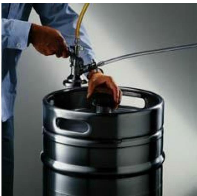
Zum Abnehmen des Zapfkopfes ziehen Sie den Hebel nach oben und nehmen den Zapfkopf vom Verschluss. Danach die Schutzkappe bitte wieder auflegen.
