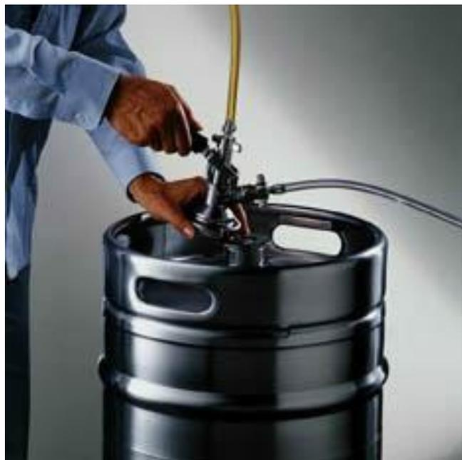
Schieben Sie den Zapfkopf mit den angeschlossenen Bier- und Kohlensäureleitungen bis zum Anschlag über den Verschluss.
